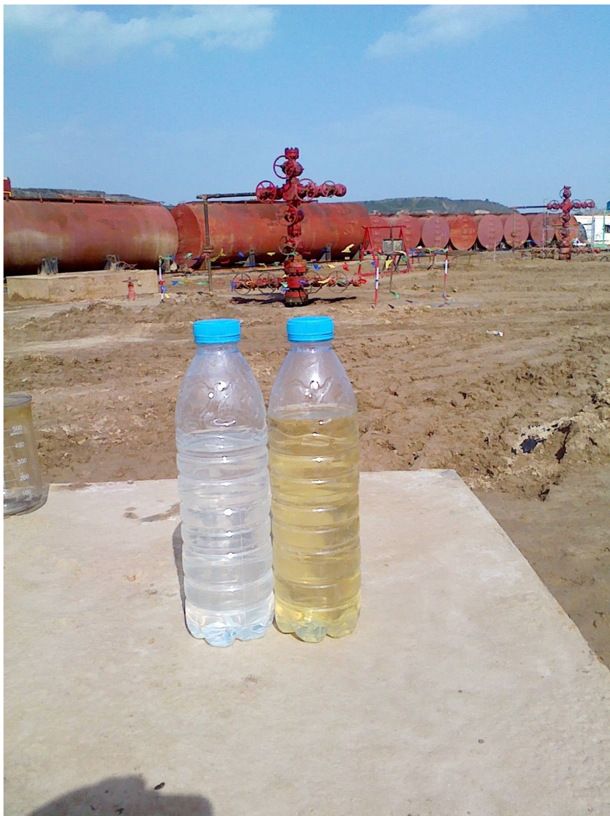
左侧药剂处理出水；右侧预处理出水
